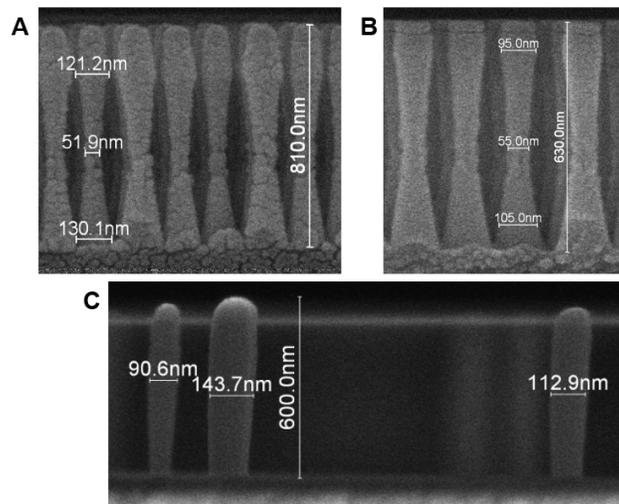
Figure 4. A) Dense post etch 750nm deep Nb<sub>2</sub>O<sub>5</sub>. B) Dense post clean 610nm deep Nb<sub>2</sub>O<sub>5</sub> C) Isolated various CD post etch 600nm Nb<sub>2</sub>O<sub>5</sub>
